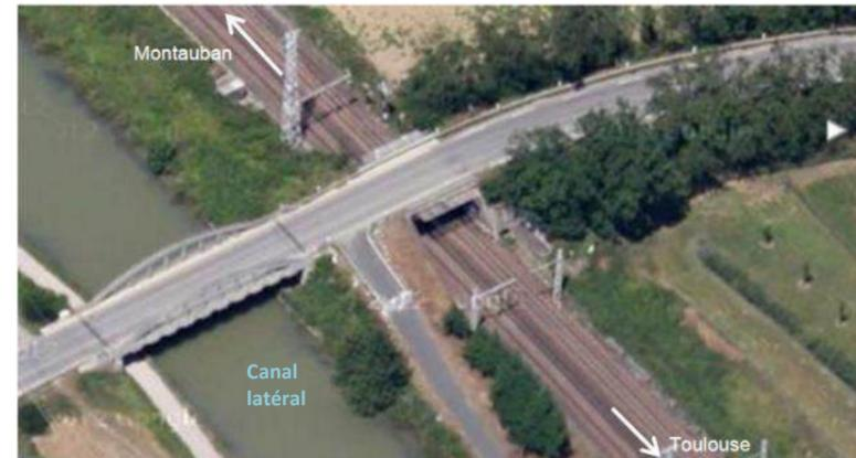
Il est situé au Km 234+775 et enjambe les deux voies de Bordeaux-Sète. Son ouverture droite (largeur ferroviaire utile) est de 8,90 m et la voirie portée est constituée d'une chaussée de 5,50 m bordée de 2 trottoirs de 1 m (non comptées les surlargeurs présentes pour la circulation des réseaux).
