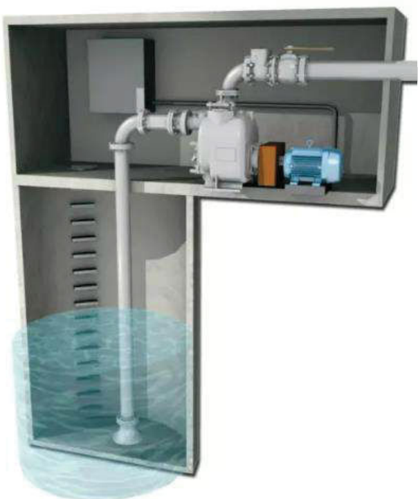
Figure 13 : Exemple de fosse de relevage avec deux compartiments
