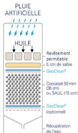
Figure 4 : Lysimètre type parking à revêtement perméable
