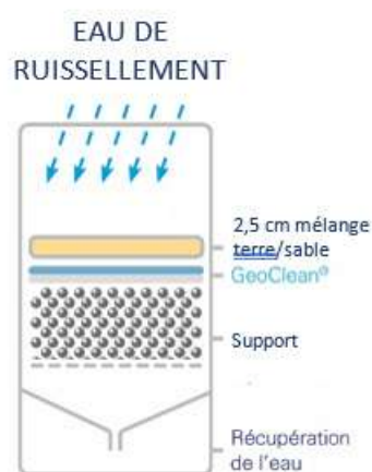
Figure 3 : Lysimètre type ouvrage d'infiltration à ciel ouvert
