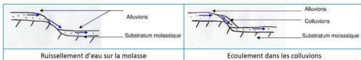
Figure 11. Ecoulements en bordure de terrasse (rapport BRGM n°55877)
