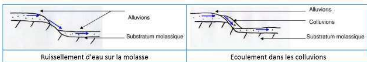
Figure 11. Ecoulements en bordure de terrasse (rapport BRGM n°55877)
