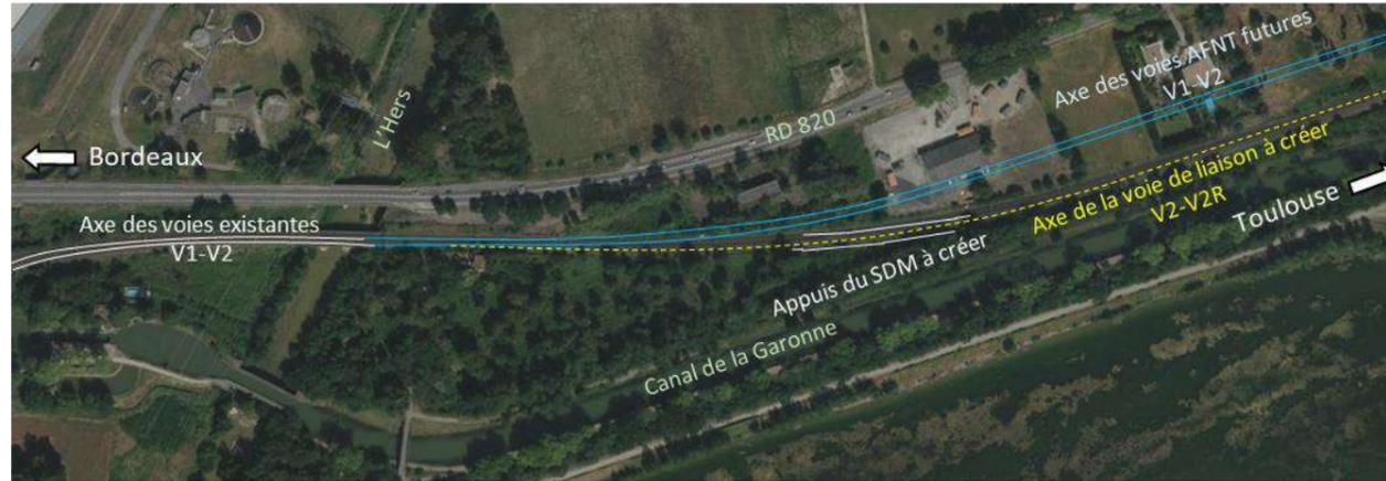
Figure 17 : Vue en plan de la future zone de raccordement : Situation cible après la mise en service de la LN (Source : SNCF Réseau)
