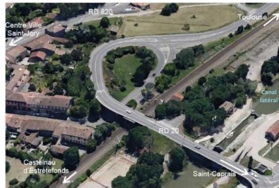
Au franchissement du pont-route, la voirie est portée à une largeur de 13 m (chaussée véhicules de 6,20 m, bordée de part et d'autre d'une voie cyclable de 2m et d'un trottoir de 1,40 m). Entre les voies ferrées et le canal latéral, l'ouvrage est équipé d'une rampe côté sud (impasse de l'écluse) qui permet d'accéder à la berge Est de l'écluse du canal, au boulo-drome situé au nord du pont, à la cour de gare de Saint-Jory et à l'ex-maison de garde de passage à niveau, toujours habitée.
