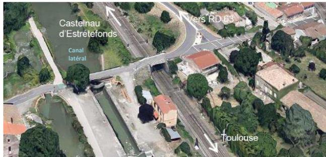
Au franchissement de l'ouvrage, la rue du moulin a une largeur de 3,40 m, constituée d'une chaussée de 2,7 m (sens privilégié de l'ouest vers l'est) et d'un trottoir unique de 0,70 m côté sud.
