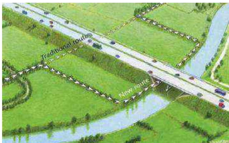
Figure 60 : Principe de rétablissement des routes de vol des chauves-souris (Source : Limpens H.J.G.A., P. Twisk P. & G. Veenbaas, 2005)
