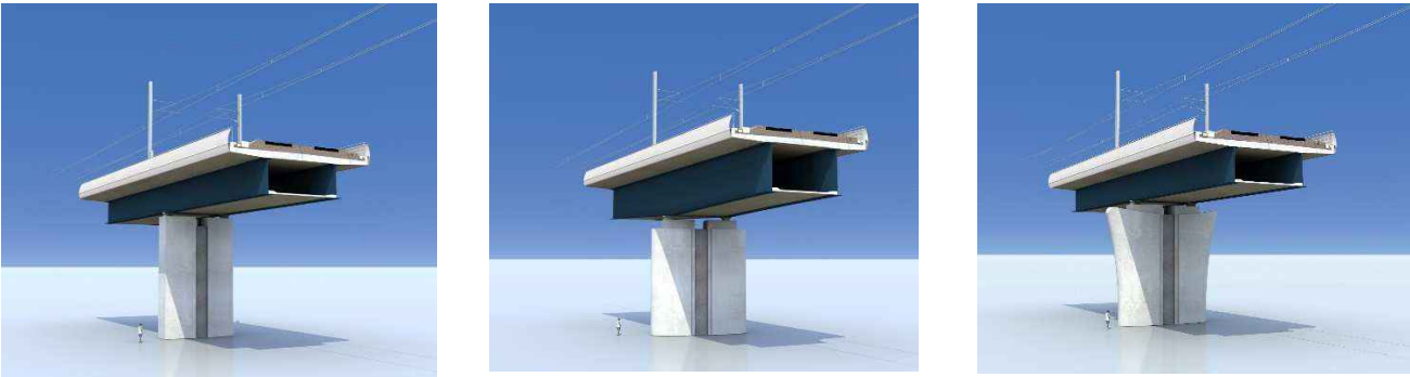
Figure 72 : Piles vallée, rivière et classique (source : Egis)
