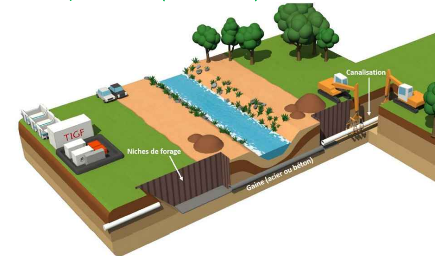
Schéma de principe de mise en place d'un franchissement par fonçage / forage horizontal / microtunnelier (Source : TEREGA)
