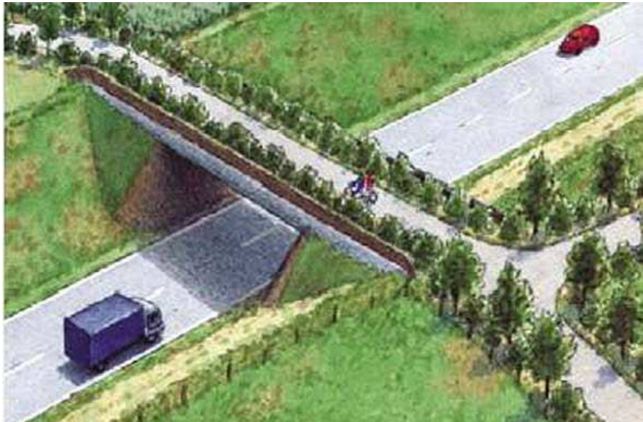
Figure 149: Un pont planté de linéaires de buissons peut guider les chauves-souris à traverser une voie routière ou ferroviaire (d'après Limpens H.J.G.A., P. Twisk P. et G. Veenbaas, 2005)
