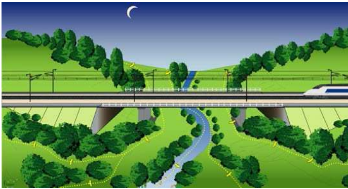
Figure 151: Amélioration de la transparence vis-à-vis des chauves-souris par aménagement de la structure de la végétation aux abords d'un viaduc (Source : Ecosphère)
