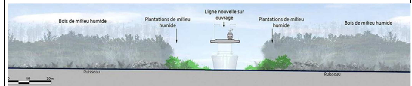
Figure 228: Coupe de principe du franchissement de milieux humides en ouvrages d'art (Source : Egis, 2013)
