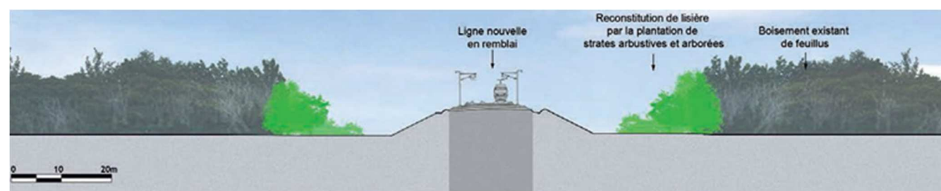
Figure 227: Coupe de principe de reconstitution de lisière de boisement de feuillus (Source : Egis, 2013)
