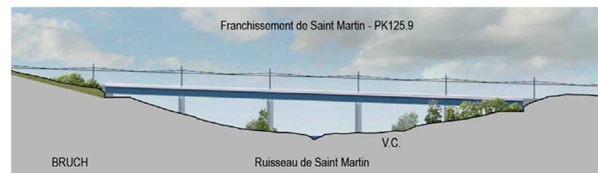
Figure 200: Profil en long du viaduc du ruisseau Saint-Martin, commune de Bruch (Source : Egis, 2013)
