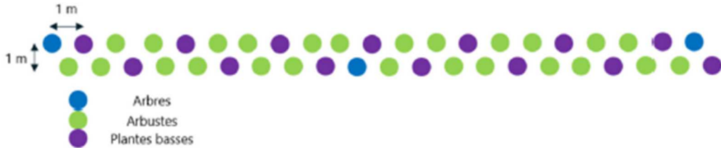
Figure 344 : Schéma de principe de plantation – Egis
