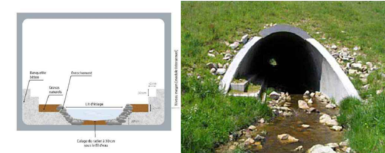
Figure 91 : Ouvrage de type 2, cadre avec reconstitution du lit aménagé ou non de banquettes (Source : Egis)
