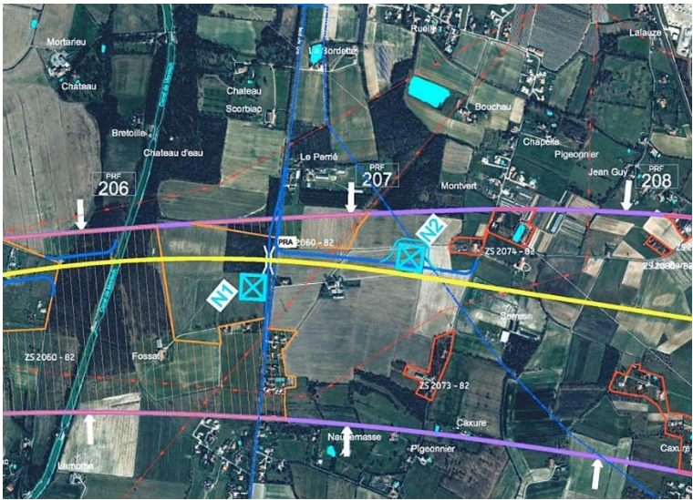
Figure 308: Variantes d'implantation proposées (sous-station N : Montauban)
