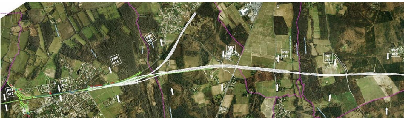
Figure 286: Solution 1ter : déviation de la ligne existante et franchissement du Saucats par 2 viaducs pour ligne nouvelle et par 1 viaduc pour la ligne existante déviée
