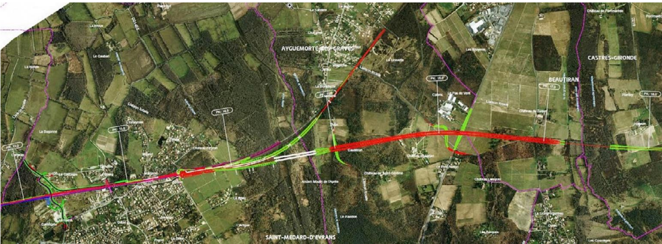
Figure 286: Solution 1ter : déviation de la ligne existante et franchissement du Saucats par 2 viaducs pour ligne nouvelle et par 1 viaduc pour la ligne existante déviée
