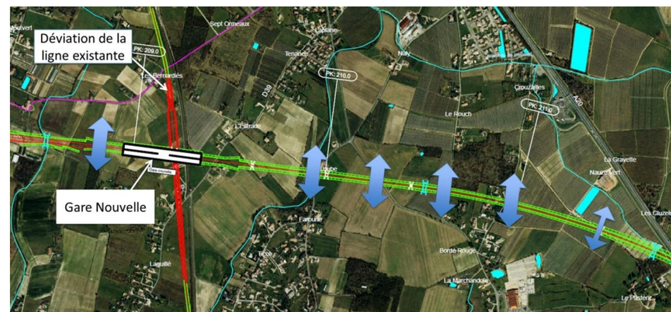
Figure 301: Proposition d'aménagement à Bressols, avec déviation de la ligne existante Toulouse-Montauban par l'ouest (rétablissements routiers en cours de finalisation)
