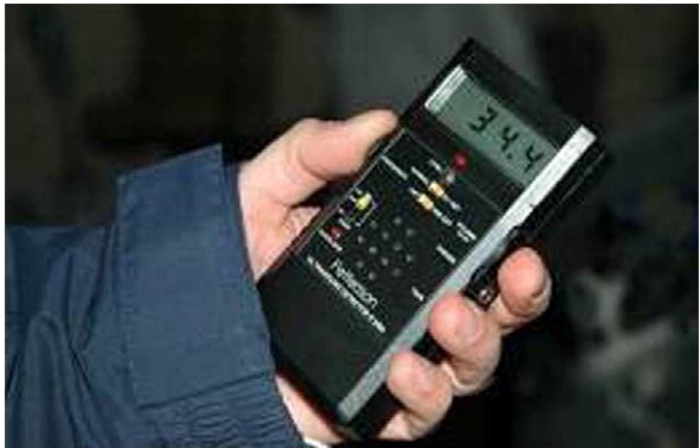
Figure 397: Détecteur en expansion de temps (Source : Écosphère)
