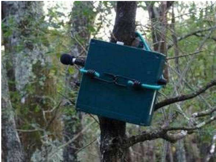
Figure 397: Détecteur en expansion de temps (Source : Écosphère)
