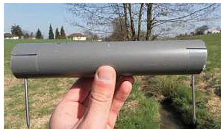
Figure 412: Vue de face du tube, avec le ruban adhésif doubles-faces et les appâts au milieu du tube (Source : R. D'Agostino Écosphère)
