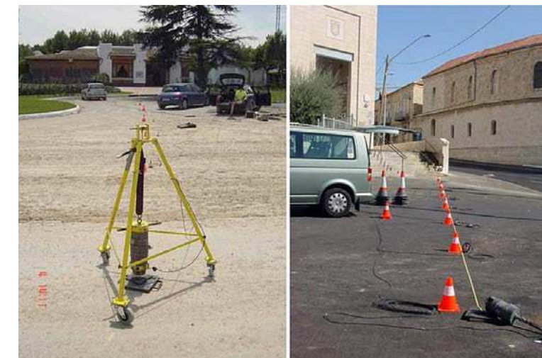
Figure 251: Dispositif de mesure de la transmissibilité linéaire du sol (Source : D2S, 2012)
